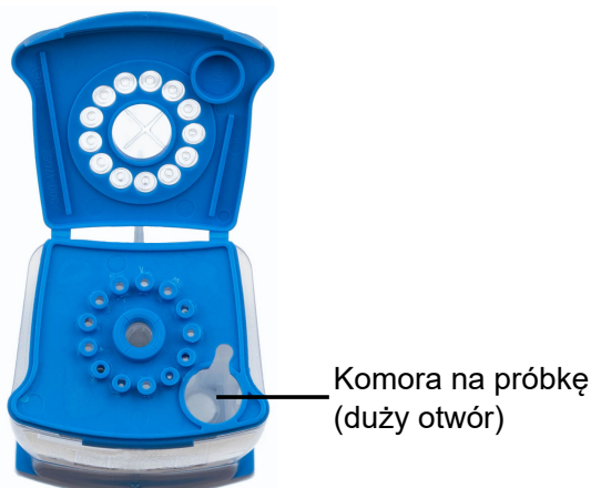
Ilustracja 5. Kartridż testu Xpert Xpress CoV-2 plus (widok z góry)
