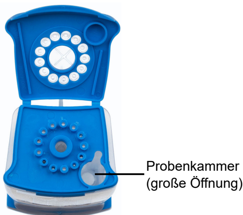
Abbildung 5. Xpert Xpress CoV-2 plus -Kartusche (Draufsicht)
