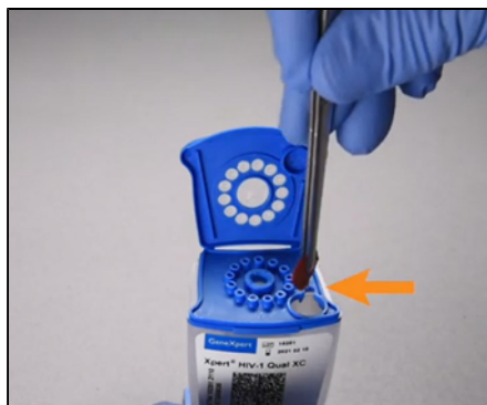
рис. 5. Введення СКК у призначену для зразка камеру
