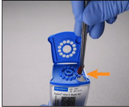
Şekil 5. DBS'nin Örnek Bölmesine Yerleştirilmesi
