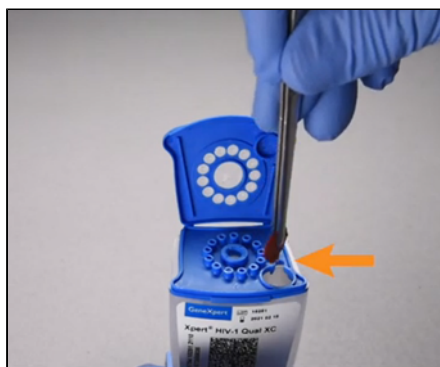
Figur 5. Införande av DBS i provkammaren
