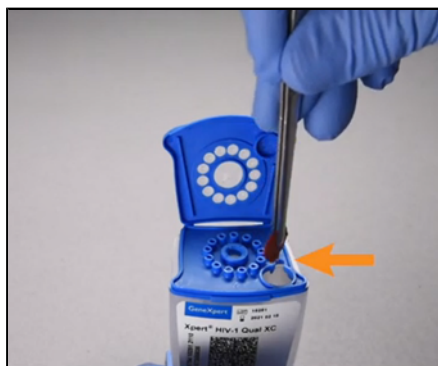
Slika 5. Umetanje DBS u komoru za uzorke
