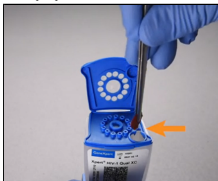
pav. 5. SKL įdėjimas į mėginių kamerą
