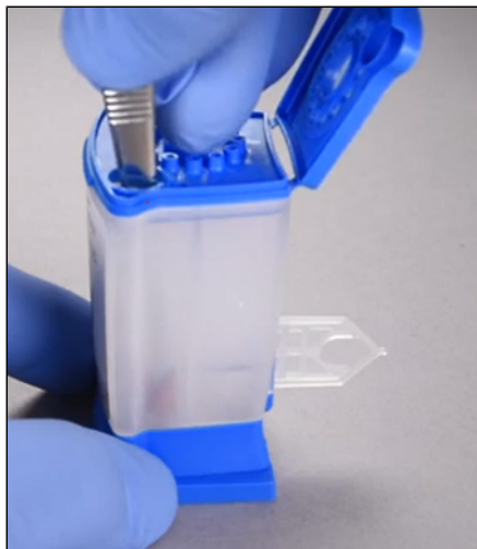
pav. 6. SKL sulankstyta mėginio kameros apačioje
