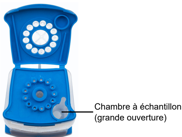
Figure 3. Cartouche Xpert HIV-1 Qual XC (vue de dessus)
