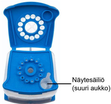
Kuva 3. Xpert HIV-1 Qual XC -kasetti (ylhäältä katsottuna)
