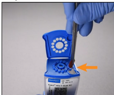
Joonis 5. KVL-i sisestamine proovikambris
