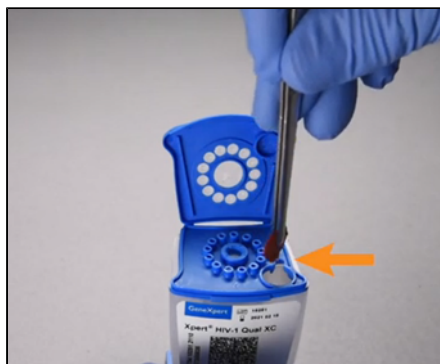
Фигура 5. Въвеждане на DBS в камерата за проби
