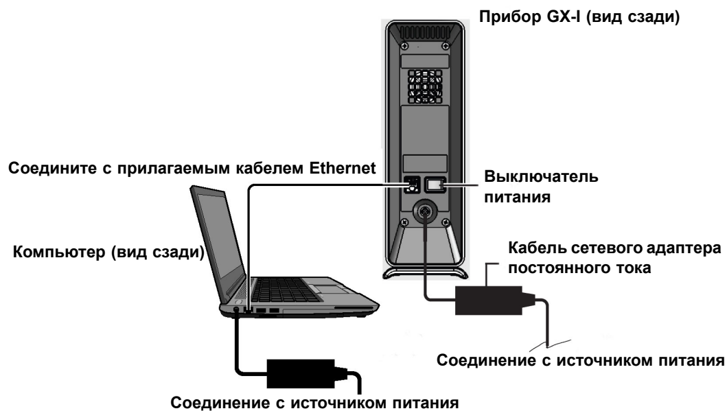
Рисунок 2-5. Подключение прибора GX-I к портативному компьютеру
