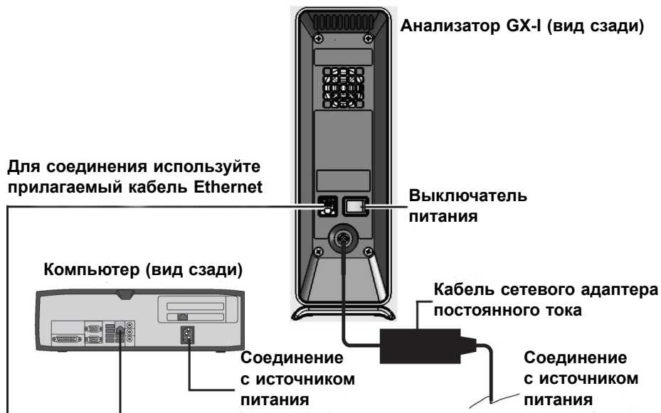
Рисунок 2-1. Подключение прибора GeneXpert GX-I к настольному компьютеру
