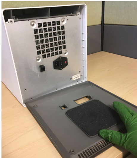
Рисунок 9-16. Замена поролонового фильтра в старых GX-IV
