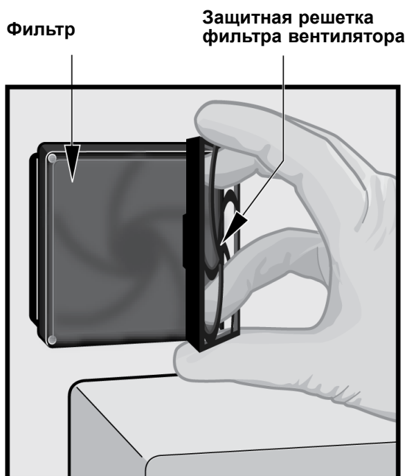
Рисунок 9-22. Удаление защитной решетки и фильтра вентилятора
