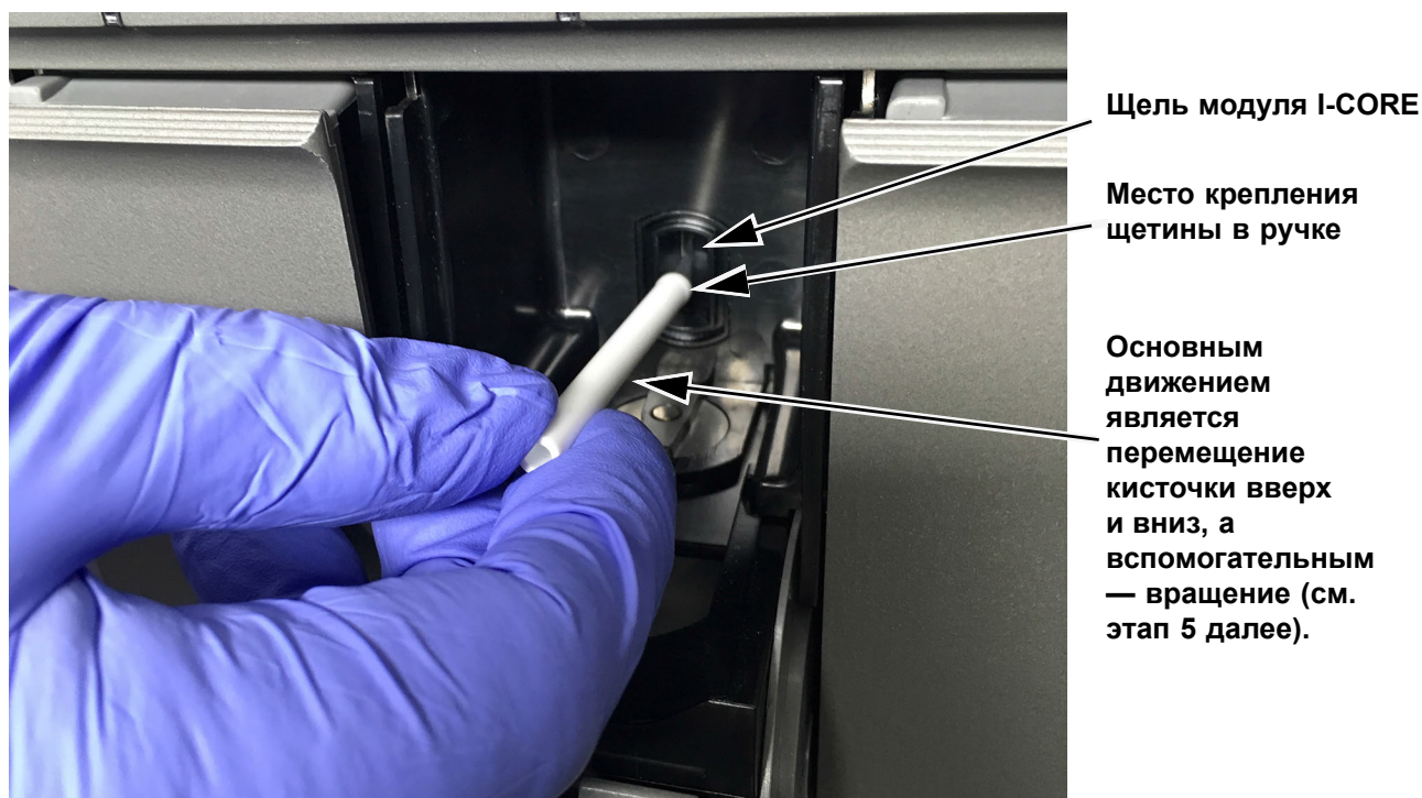
Рисунок 9-7. Введение кисточки для чистки в щель модуля I-CORE
