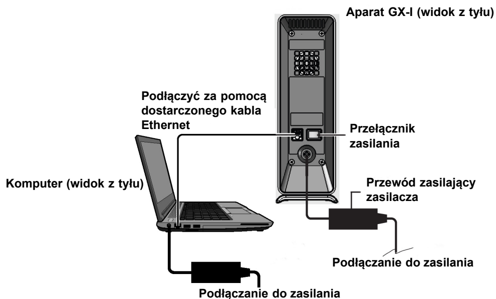
Ilustracja 2-5. Podłączanie aparatu GX-I do laptopa
