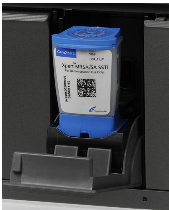
Ilustracja 5-33. Kartridż GeneXpert umieszczony w tylnej części podstawy wnęki modułu
