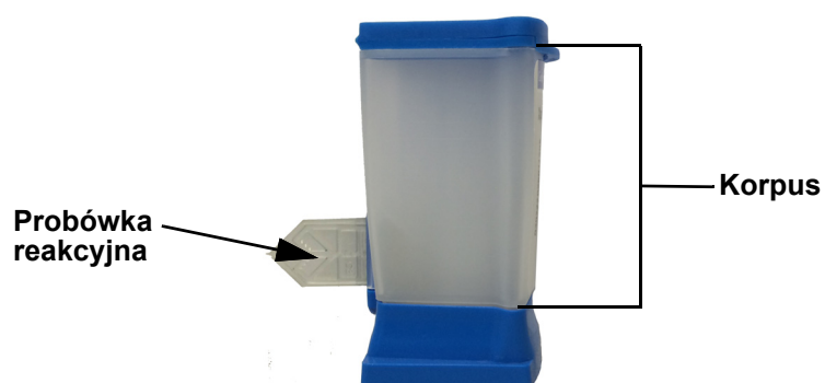
Ilustracja 5-31. Prezentacja kartridża pokazująca korpus i probówkę reakcyjną
