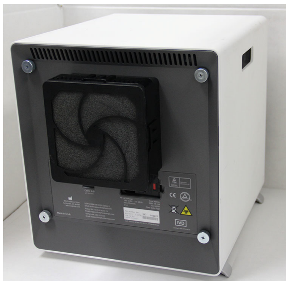
Ilustracja 9-24. Aparat GX-IV ustawiony w sposób umożliwiający dostęp do wentylatorów
