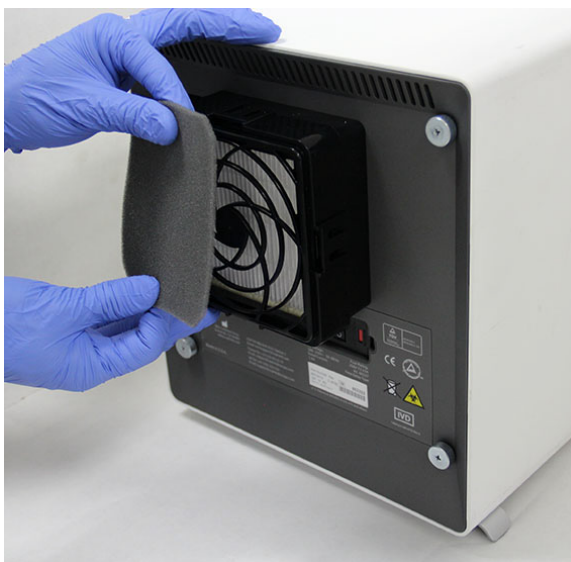
Ilustracja 9-26. Wyjmowanie filtra wstępnego
