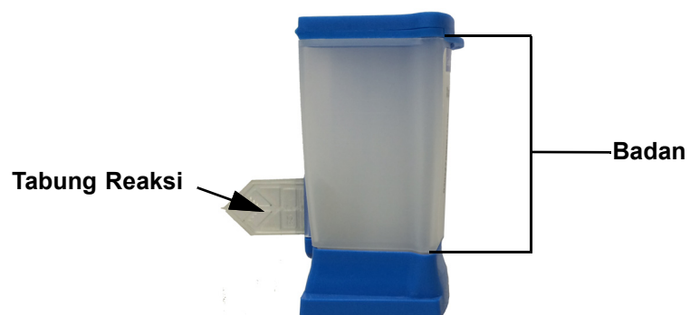
Gambar 5-31. Kartrid yang Memperlihatkan Badan dan Tabung Reaksi
