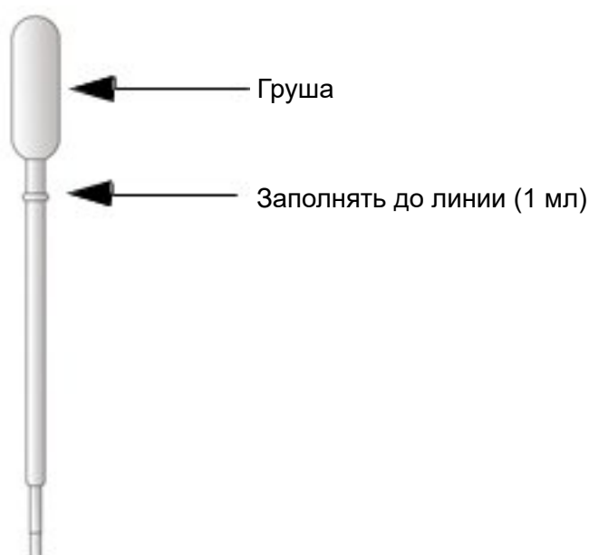
Рисунок 1. Пипетка для переноса и метка заполнения
