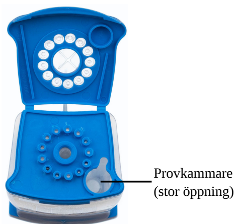
Figur 2. Xpert HPV v2-kassett (sett ovanifrån)
