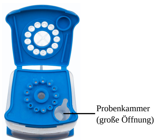
Abbildung 2. Xpert HPV v2-Kartusche (Draufsicht)
