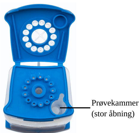
Figur 2. Xpert HPV v2-kassette (set ovenfra)
