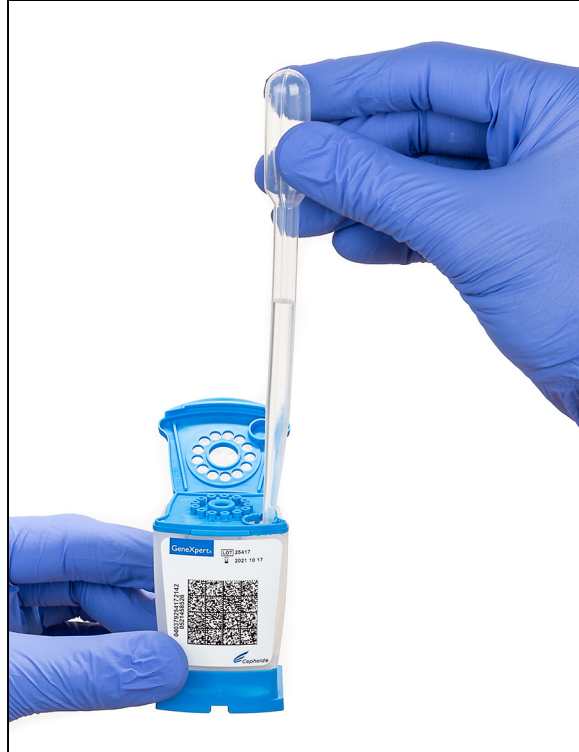
Şekil 6. Dekontamine Sıvılaştırılmış Örneğin Kartuşun Örnek Haznesine Dağıtılması
