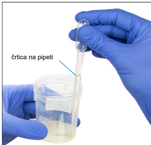
Slika 5. Aspirirajte do črte na pipeti.
