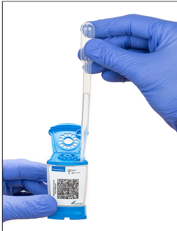
Gambar 6. Mengeluarkan Sampel Cair yang Didekontaminasi ke dalam Bilik Sampel pada Kartrid
