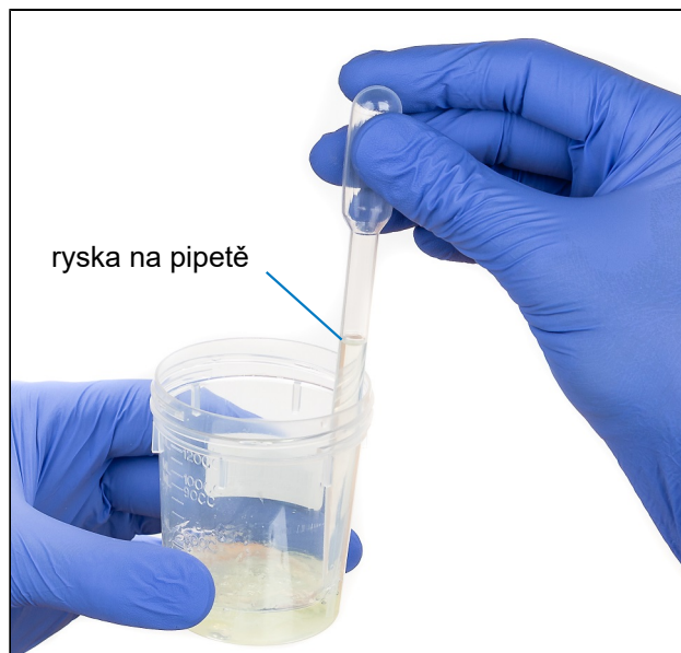
Obrázek 5. Aspirace po linku na pipetě
