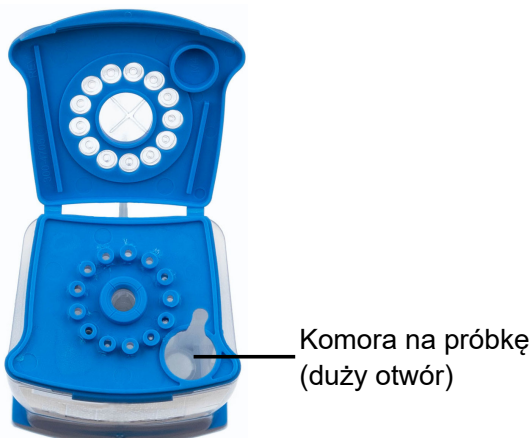
Ilustracja 3. Kartridż testu Xpert Xpress GBS (widok z góry)
