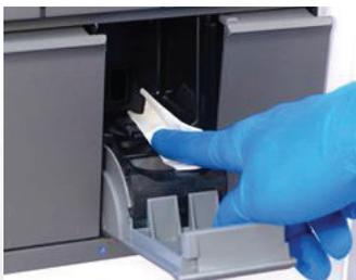
6. Humidifier une lingette non pelucheuse avec une solution d'eau de Javel ménagère à base de chlore diluée au 1:10. Essuyer la tige de piston et l'intégralité de l'intérieur du socle de cartouche avec de l'eau de Javel diluée 3 fois en laissant l'eau de Javel au contact pendant 2 minutes à chaque fois.
