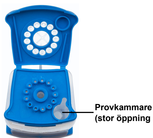
Figur 2. Xpert HPV v2-kassetten (vy från ovan)
