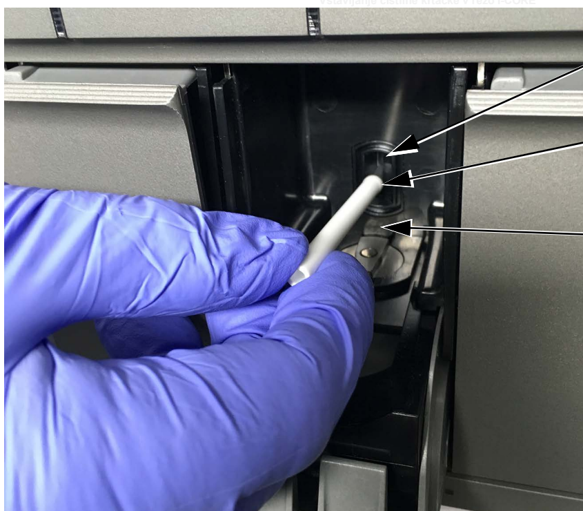
Slika 2-2. Vstavljanje čistilne krtačke v režo I-CORE
