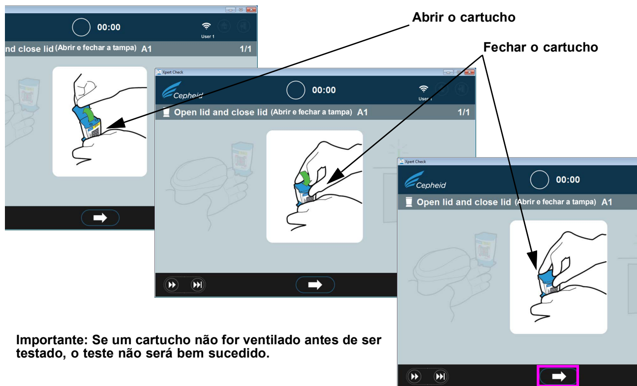
Figura 2-16. Ventilação do cartucho mediante abertura e fecho da tampa — ecrã animado
