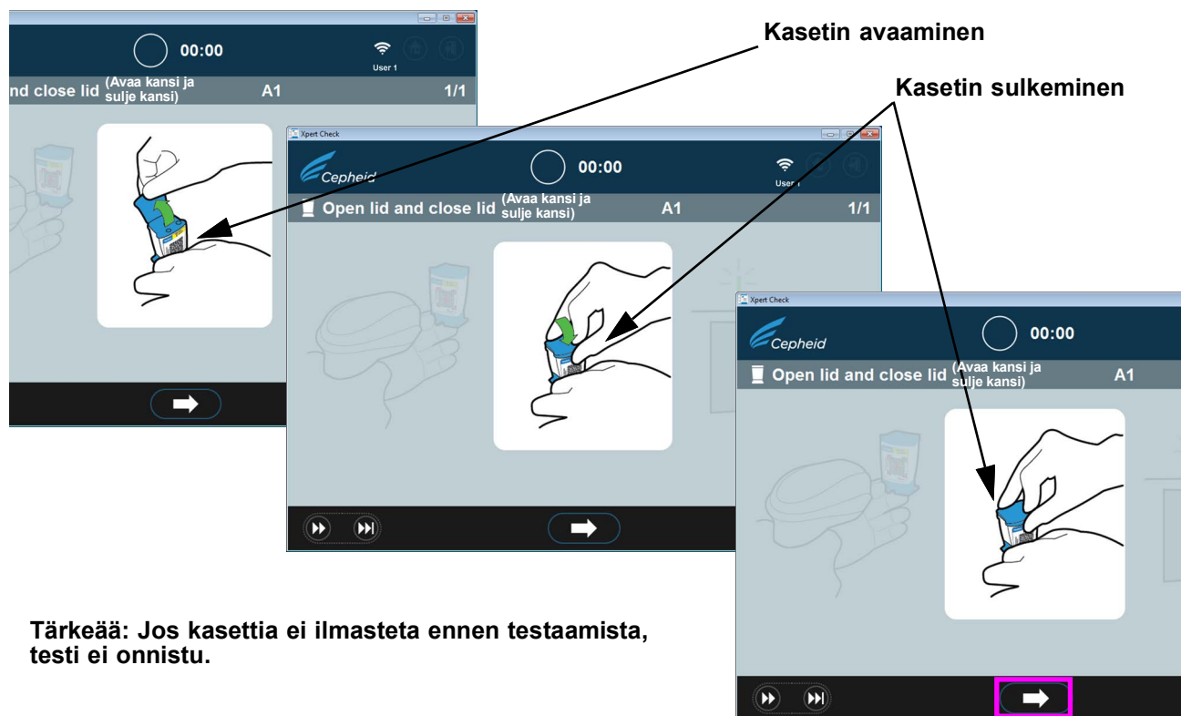
Kuva 2-16. Kasetin ilmastaminen kasetin kanta avaamalla ja sulkemalla - animoitu näyttö
