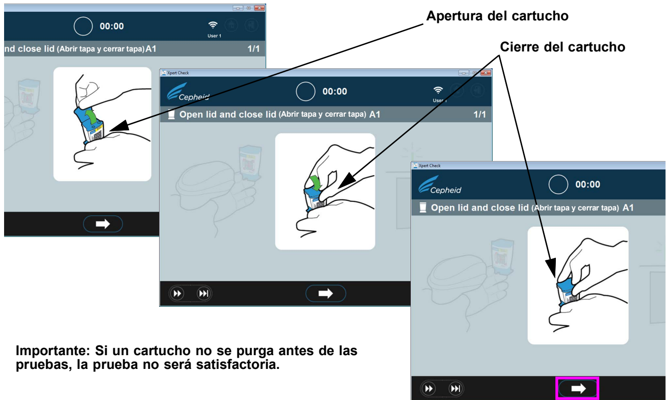
Figura 2-16. Pantalla animada de purga del cartucho mediante la apertura y cierre de la tapa del cartucho
