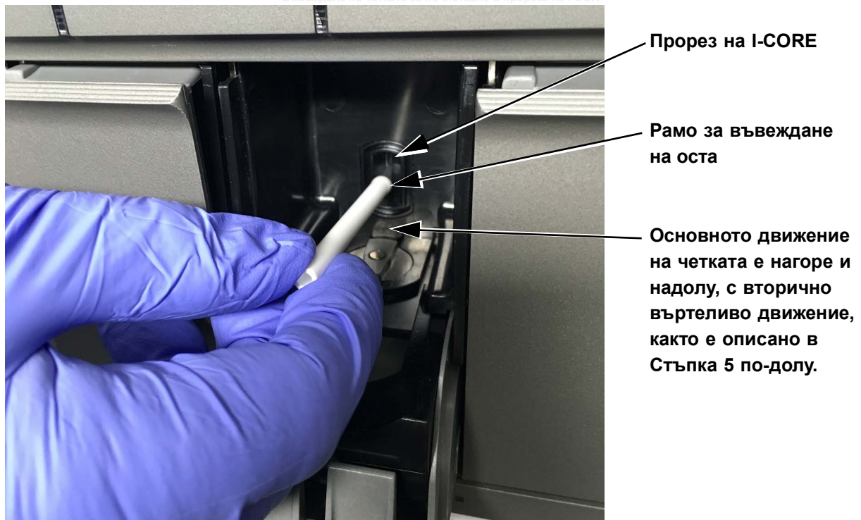
Фигура 2-2. Въвеждане на четката за почистване в прореза на I-CORE
