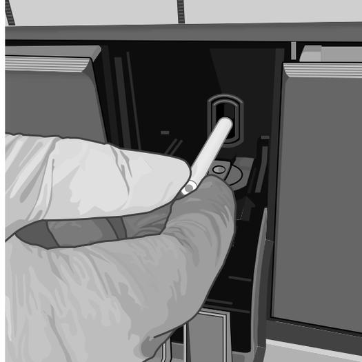
**Figura 72. Inserção da escova de limpeza na ranhura do módulo I-CORE**
