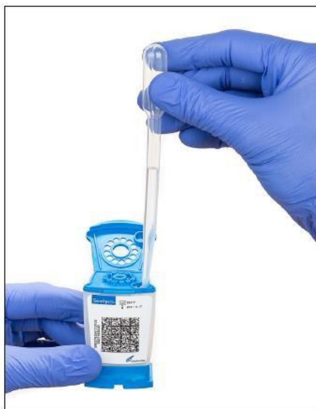
图6. 将去污染后的液化样本置入检测盒样本室
