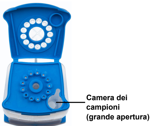
Figura 5. Cartuccia Xpert Xpress SARS-CoV-2 (vista dall'alto)
