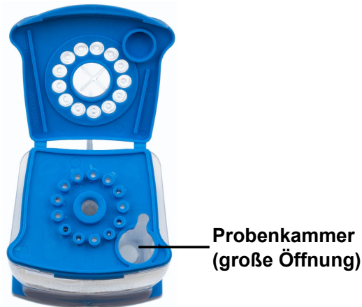
Abbildung 5. Xpert Xpress SARS-CoV-2-Kartusche (Draufsicht)
