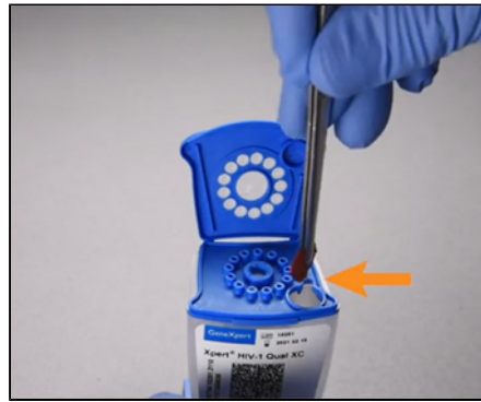
Figura 5. Inserción de la tarjeta de sangre seca en la cámara de muestras
