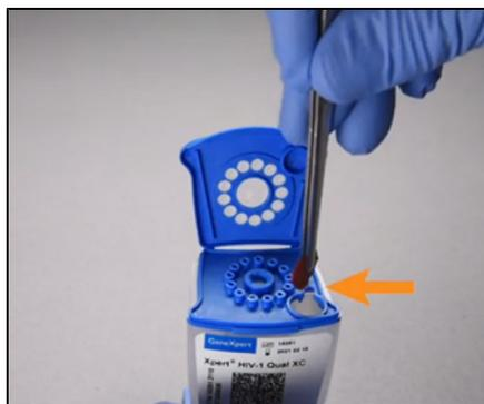
Рисунок 5. Введение СКК в камеру для образца
