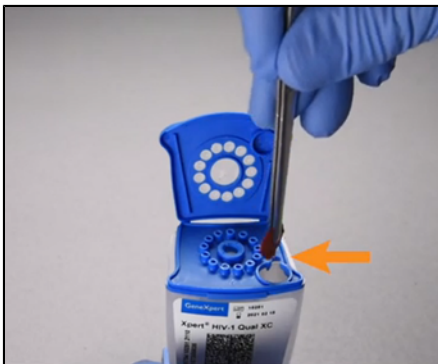
Afbeelding 5. Plaatsing van DBS in de monsterkamer
