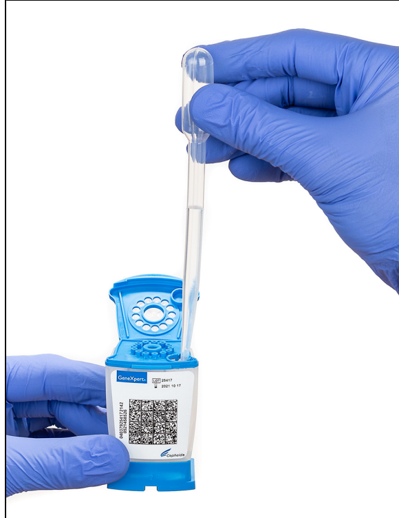
Şekil 6. Dekontamine Sıvılaştırılmış Örneği Kartuşun Örnek Haznesine Dağıtılması
