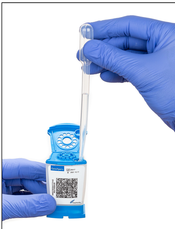
Obrázok 6. Dávkovanie dekontaminovanej skvapalnenej vzorky do vzorkovacej komory kazety
