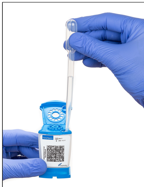
Слика 6. Дозирање деконтаминиран втечнет примерок во комората за примероци на патронот
