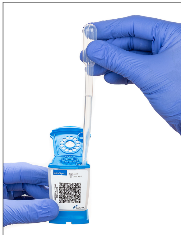
Figure 6. Distribution de l'échantillon liquéfié décontaminé dans la chambre pour échantillon de la cartouche
