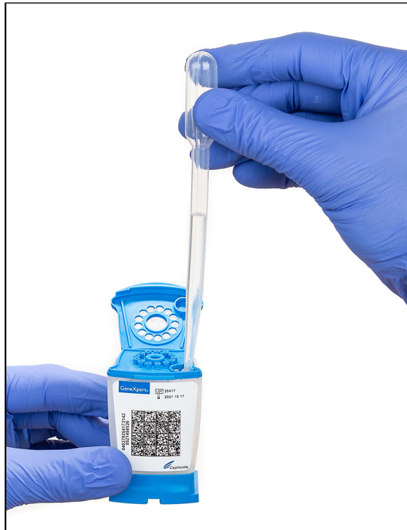
Kuva 6. Dekontaminoidun nestemäisen näytteen annosteleminen kasetin näytekammioon
