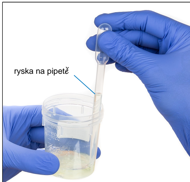
Obrázek 5. Aspirace po linku na pipetě
