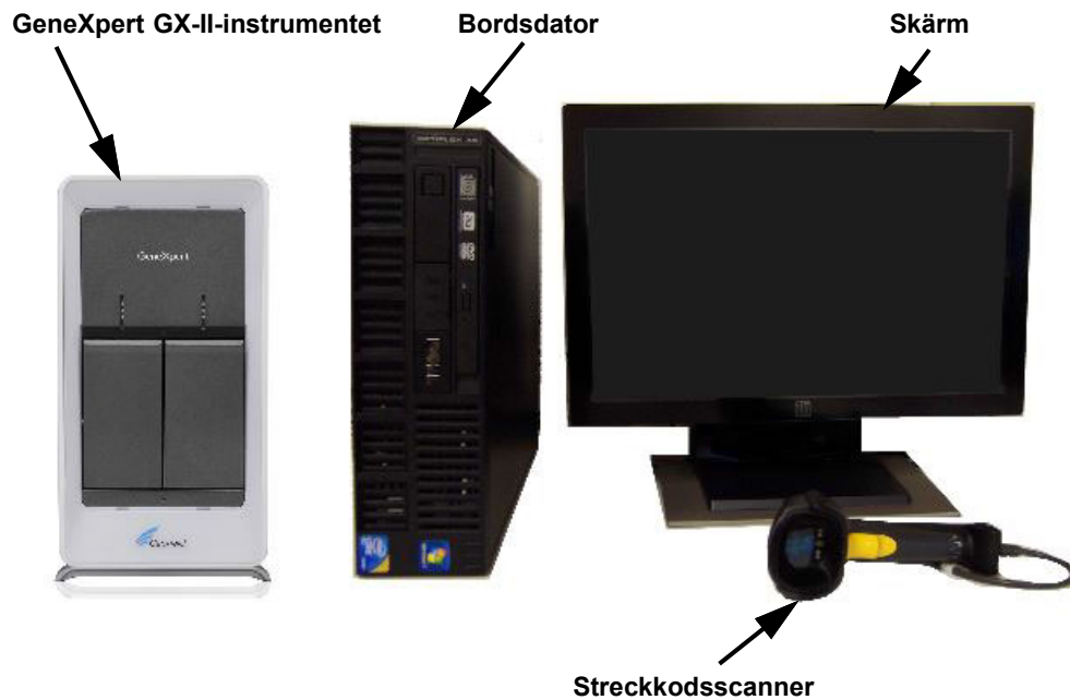
Figur 1-5. GeneXpert GX-II-hårdvarans komponenter (visas med bordsdatorn)
