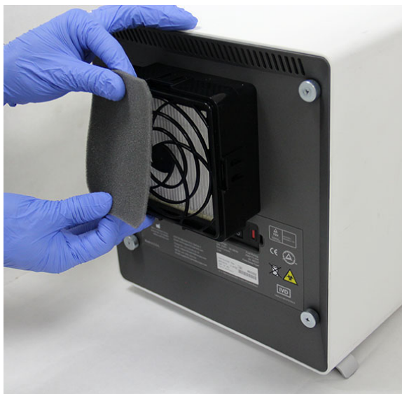
Figur 9-26. Borttagning av förfiltret
