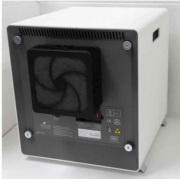
Figur 9-24. GX-IV-instrumentet placerat för åtkomst till filter
