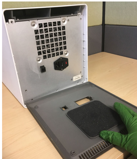
Figur 9-16. Byta ut skumfilter i äldre GX-IV
