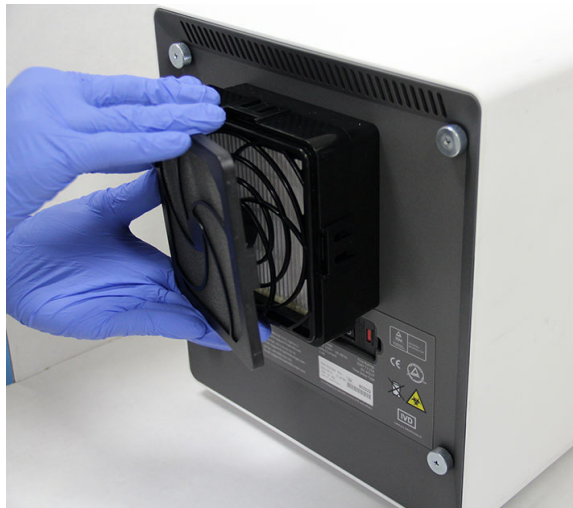
Figur 9-25. Borttagning av förfiltrets hållare
