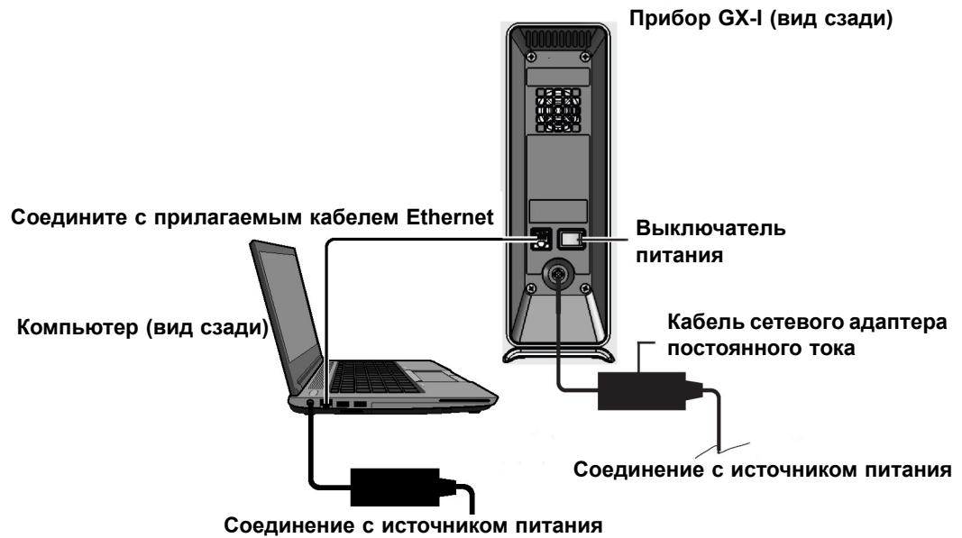
Рисунок 2-5. Подключение прибора GX-I к портативному компьютеру
