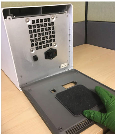
Рисунок 9-16. Замена поролонового фильтра в старых GX-IV
