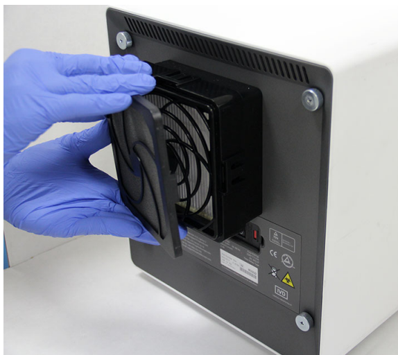
Рисунок 9-25. Снятие держателя предфильтра
