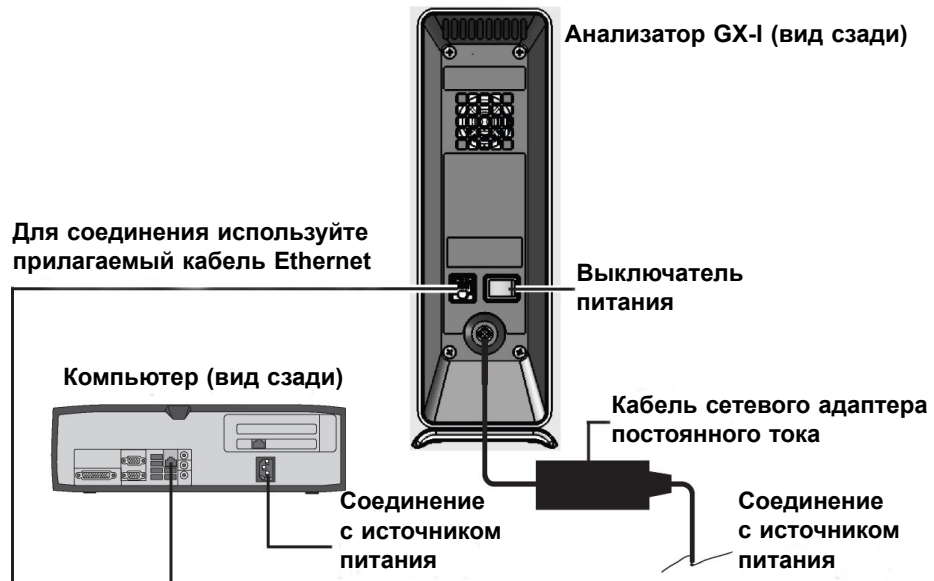
Рисунок 2-1. Подключение прибора GeneXpert GX-I к настольному компьютеру
