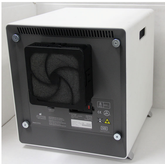
Рисунок 9-24. Анализатор GX-IV, установленный для доступа к фильтру
