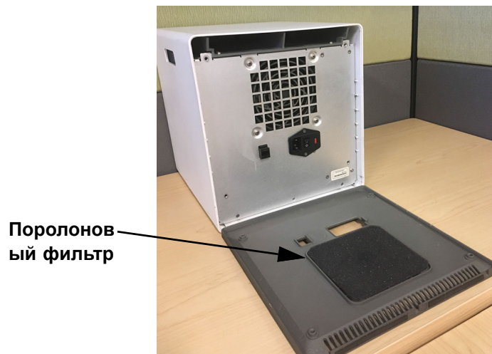
Рисунок 9-15. Поролоновый фильтр в старых GX-IV
