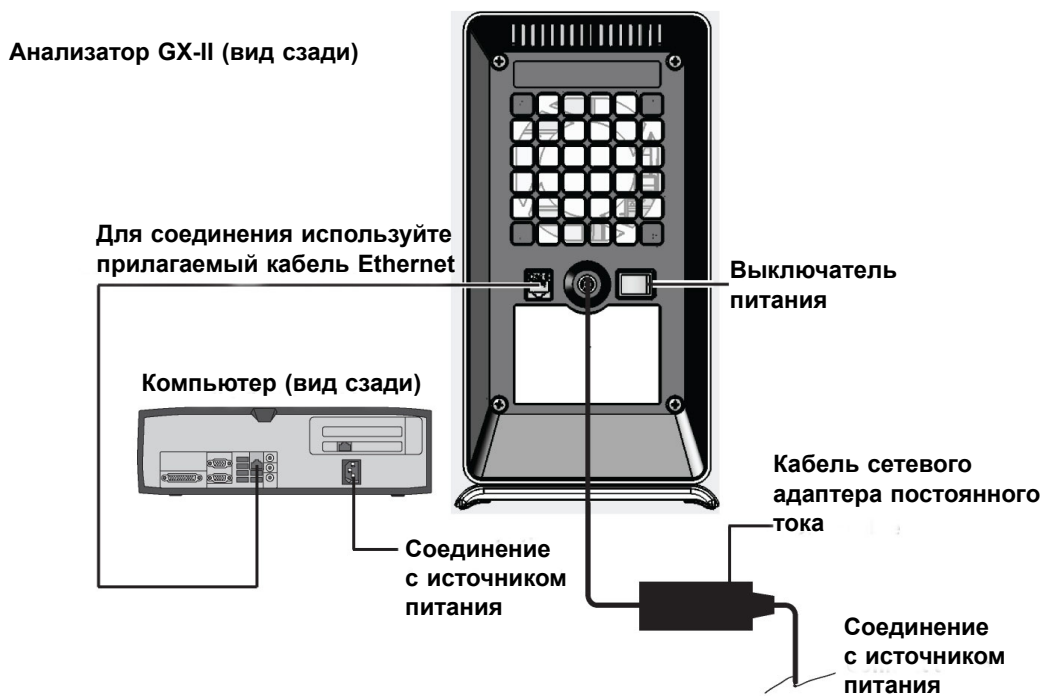
Рисунок 2-2. Подключение прибора GeneXpert GX-II к настольному компьютеру
