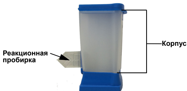
Рисунок 5-31. Картридж; показаны корпус и реакционная пробирка
