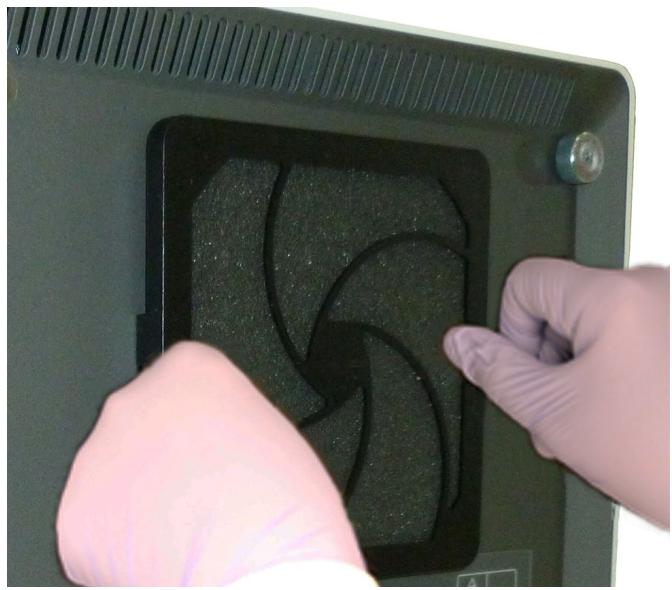
GX-IV: Pressionar as partes laterais no lugar
