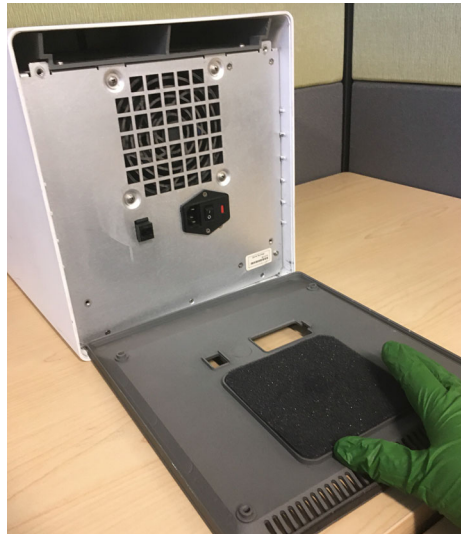
Figura 9-16. Substituir o filtro de espuma num GX-IV mais antigo
