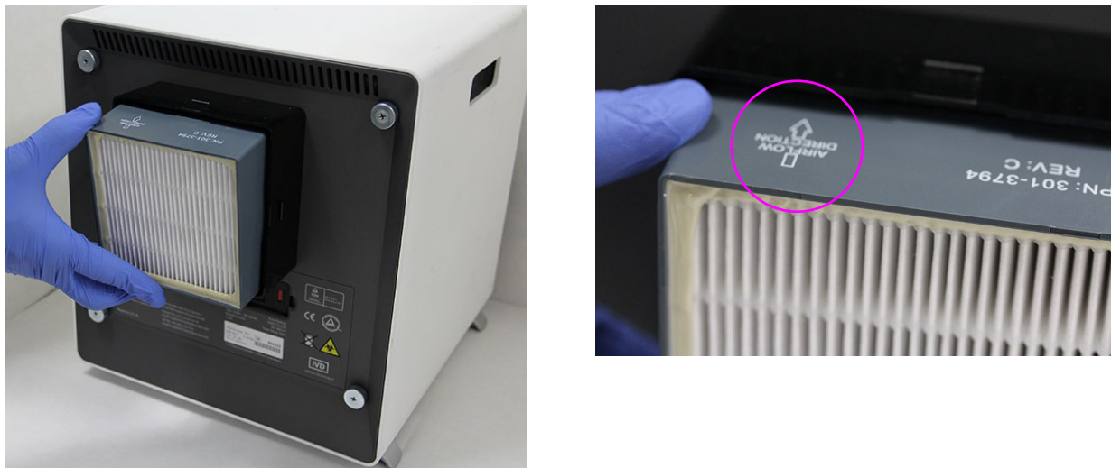
Figura 9-29. Substituição do filtro HE
