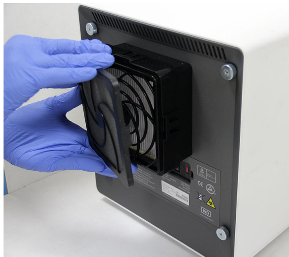
Figura 9-25. Remover o retentor do pré-filtro
