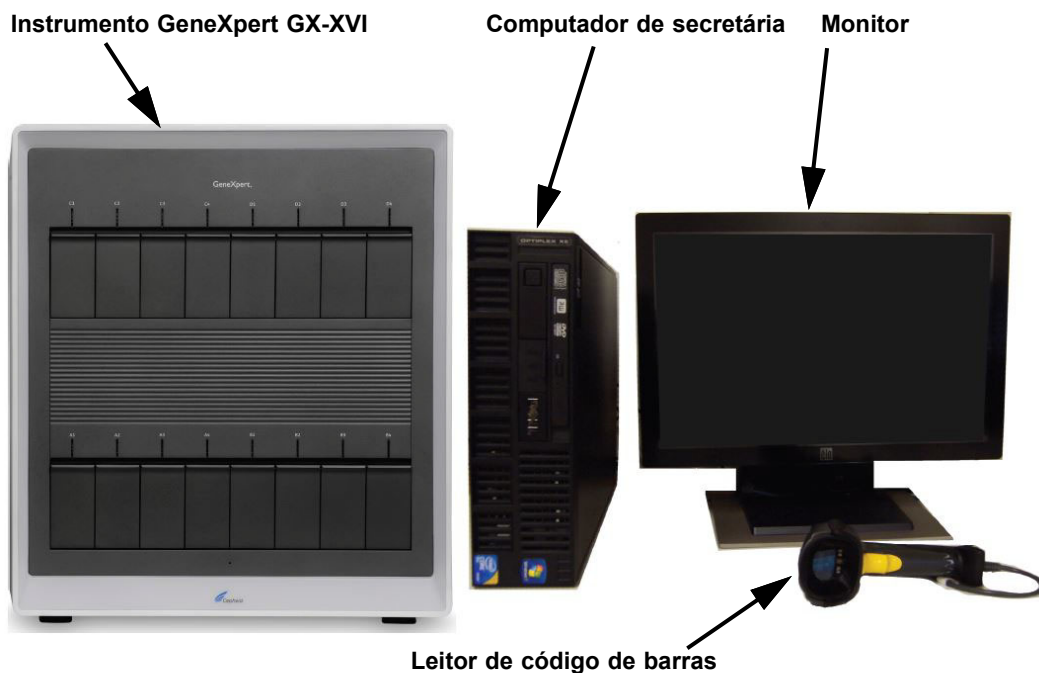
Figura 1-9. Componentes do hardware do GeneXpert GX-XVI (mostrado com o computador desktop)
