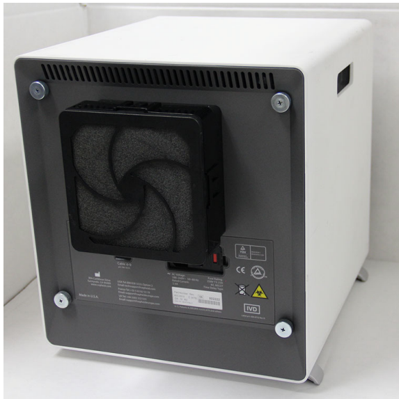
Figura 9-24. Instrumento GX-IV posicionado para acesso ao filtro
