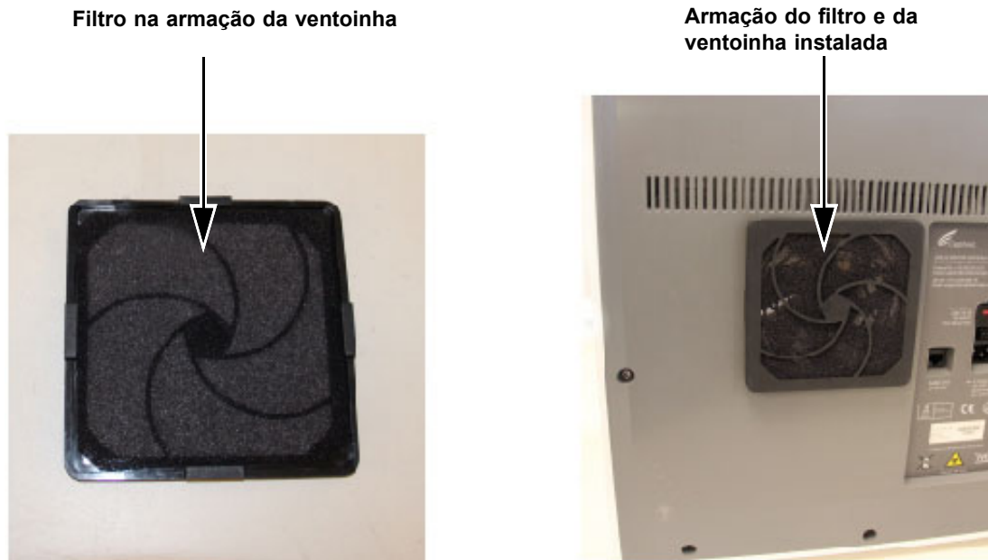
Figura 9-23. Substituir o filtro e a armação
