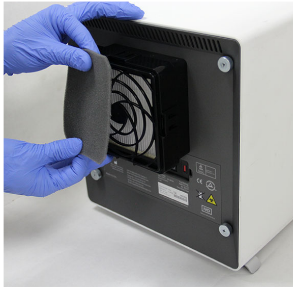
Figura 9-26. Remoção do pré-filtro
