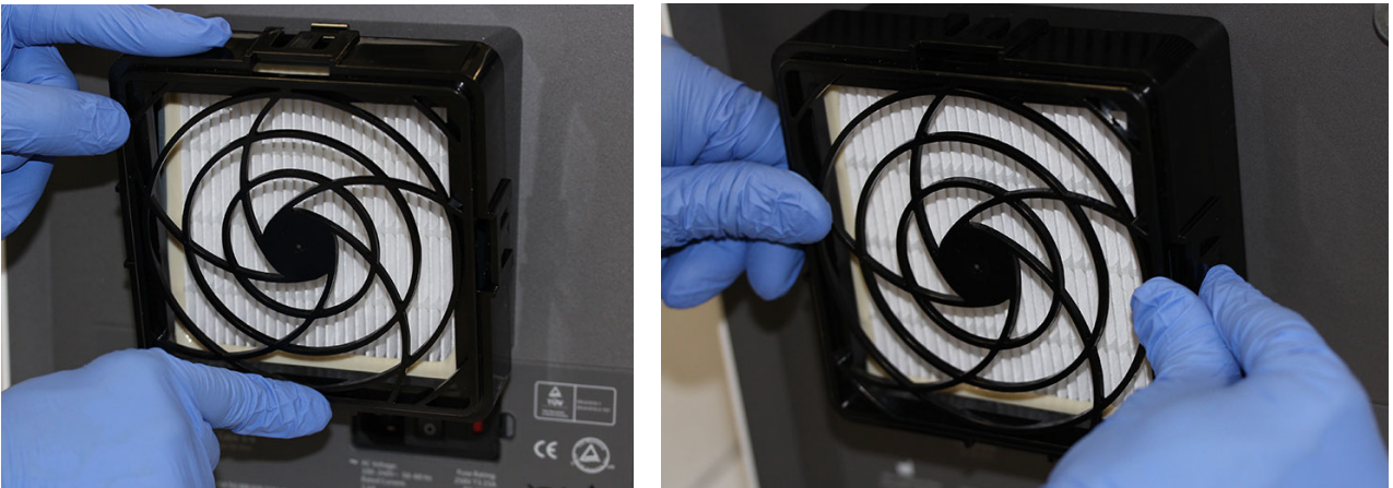
Figura 9-30. Substituição do retentor do filtro HE
