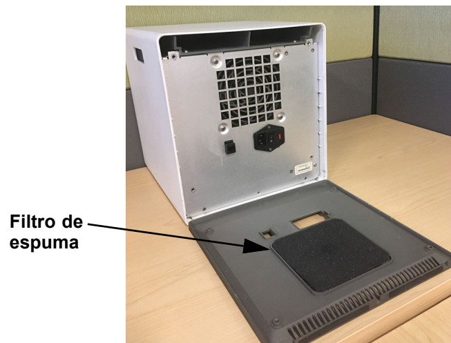
Figura 9-15. Filtro de espuma num GX-IV mais antigo
