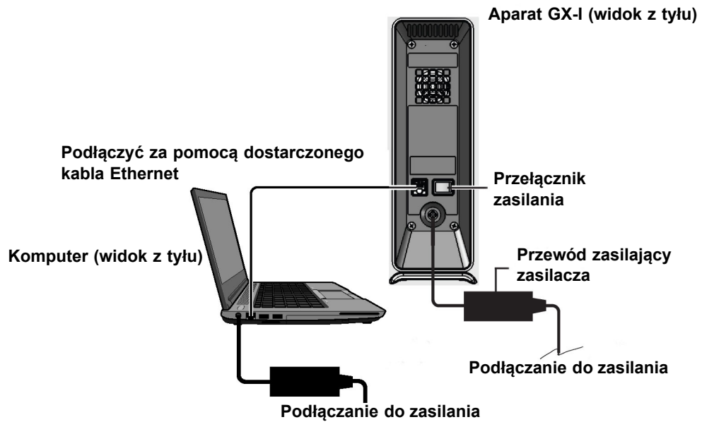
Ilustracja 2-5. Podłączanie aparatu GX-I do laptopa
