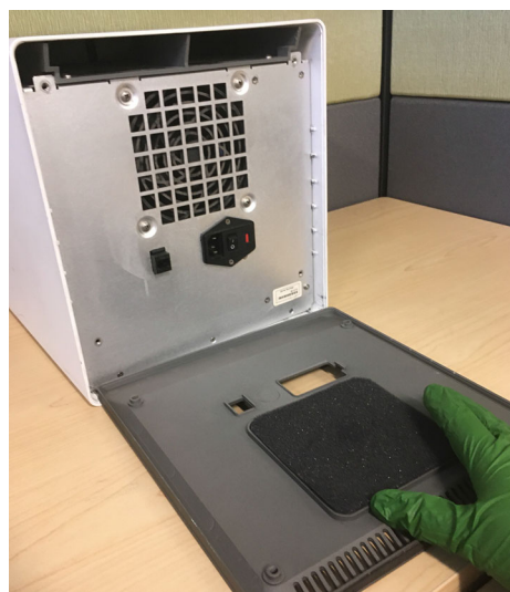
Ilustracja 9-16. Wymiana filtra piankowego w starszej wersji aparatu GX-IV
