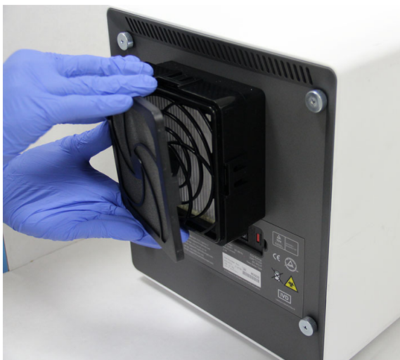
Ilustracja 9-25. Wyjmowanie ramki mocującej filtra wstępnego
