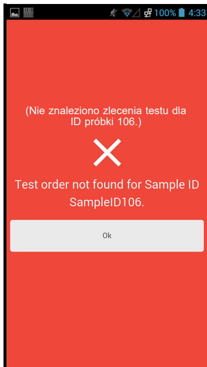
Ilustracja 5-104. Zawierający czerwoną literę X ekran skanera Cepheid Link wskazujący na wystąpienie błędu i nie odnalezienie zlecenia
