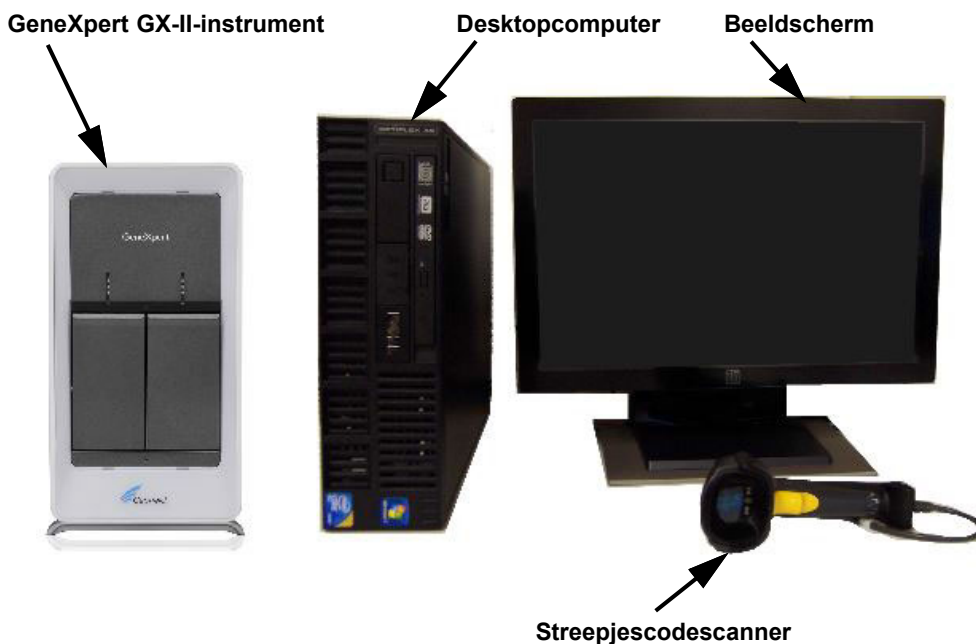
Afbeelding 1-5. GeneXpert GX-II-hardwarecomponenten (getoond met de desktopcomputer)
