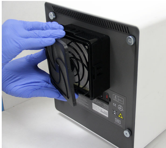
Afbeelding 9-25. De voorfilterhouder verwijderen
