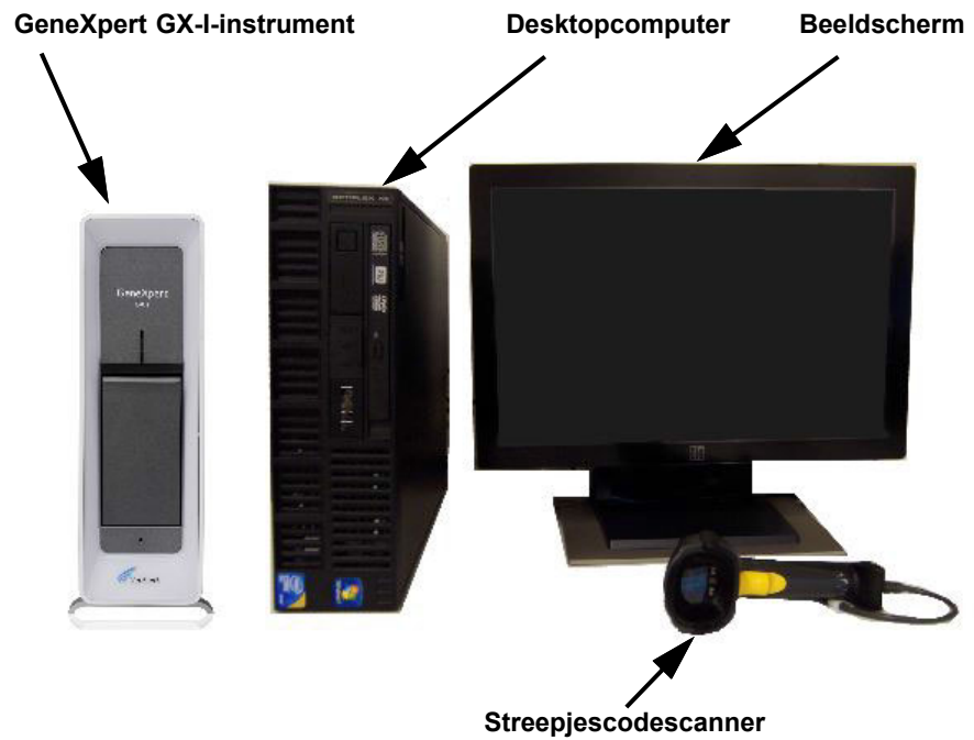
Afbeelding 1-3. GeneXpert GX-I-hardwarecomponenten (getoond met de desktopcomputer)
