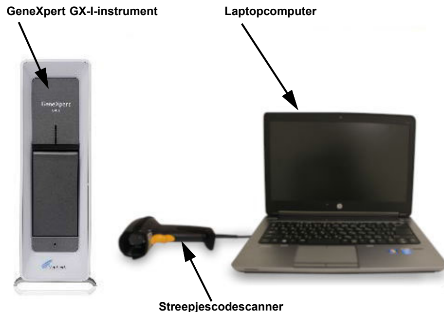
Afbeelding 1-2. GeneXpert GX-I-hardwarecomponenten (getoond met de laptopcomputer)
