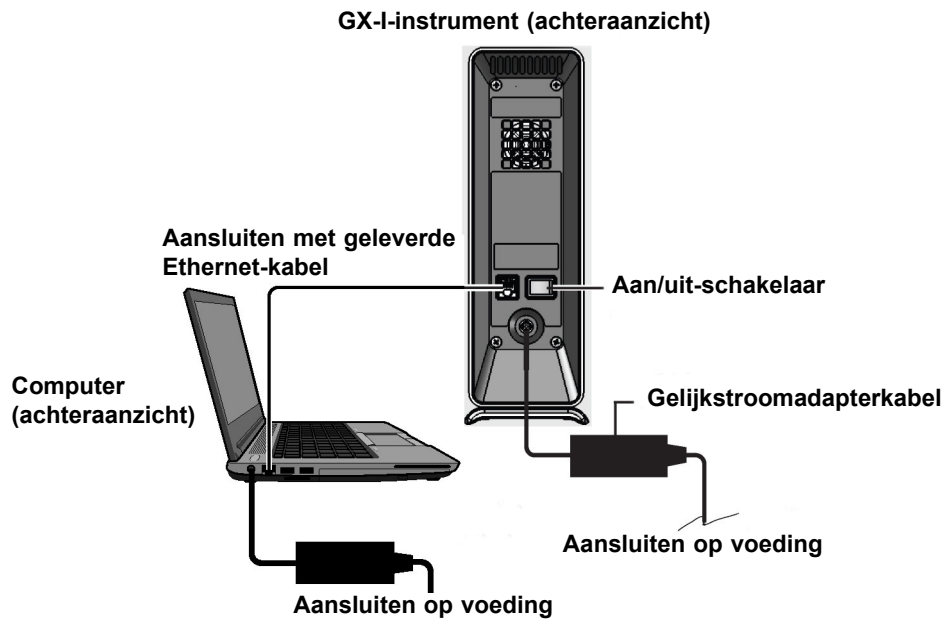
Afbeelding 2-5. Het GX-I-instrument aansluiten op de laptopcomputer
