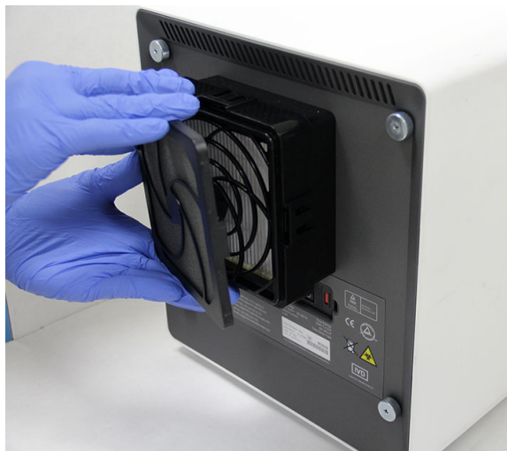
9-25. attēls. Priekšfiltra aiztura noņemšana
