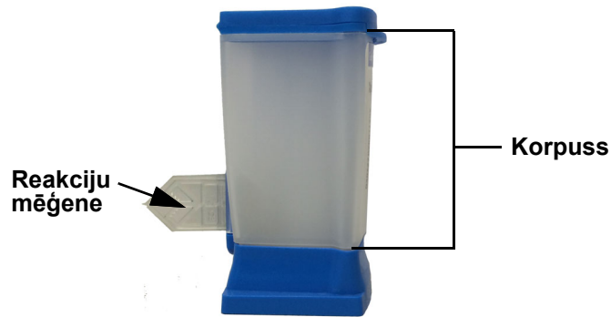
5-31. attēls. Kārtridžs, kam redzams korpuss un reakciju mēģene
