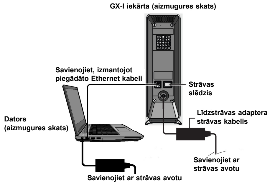
2-5. attēls. GX-I iekārtas savienošana ar klēpj datoru
