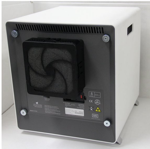
9-24. attēls. GX-IV iekārta novietota tā, lai varētu piekļūt filtram
