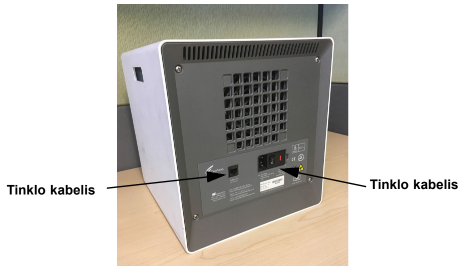
9-13 pav. Tinklo kabelis ir maitinimo kabelio vietos senesniame „GX-IV“
