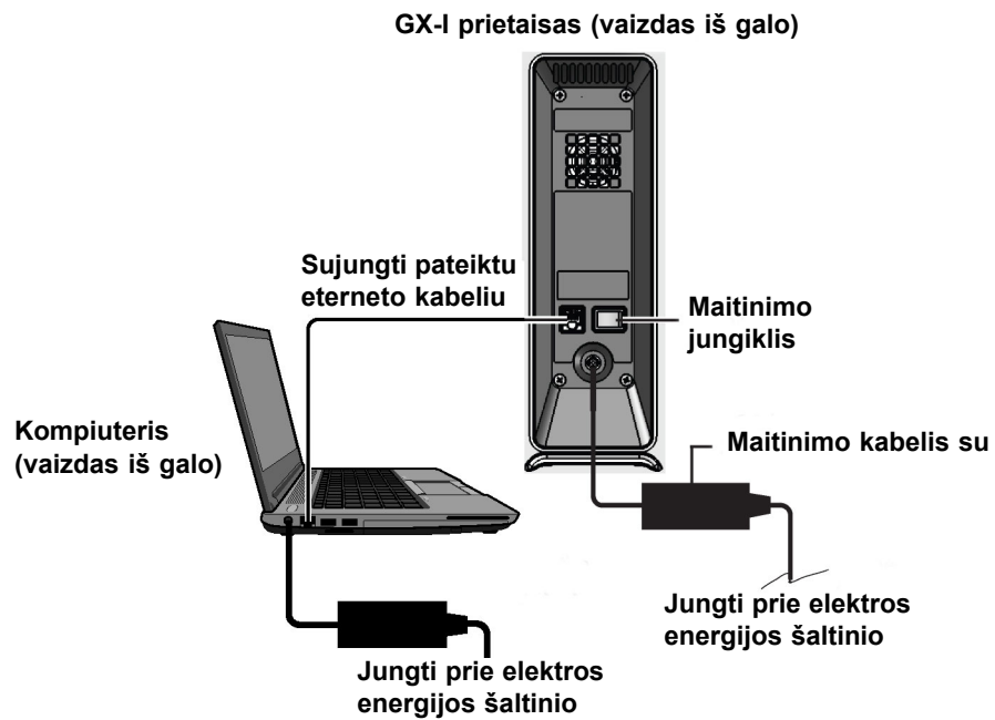
2-5 pav. GX-I prietaiso prijungimas prie nešiojamojo kompiuterio
